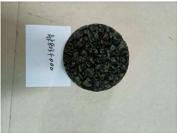
AK803+000 二车道泛白芯样分散试验
