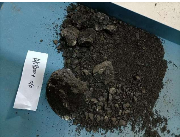
BK800+010 二车道泛白芯样分散试验
