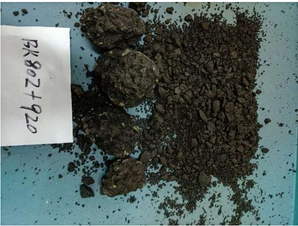
BK802+920 二车道泛白芯样分散试验 表 5-4 芯样飞散试验汇总表
