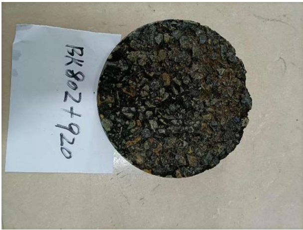
BK802+920 二车道泛白芯样分散试验 表 5-4 芯样飞散试验汇总表
