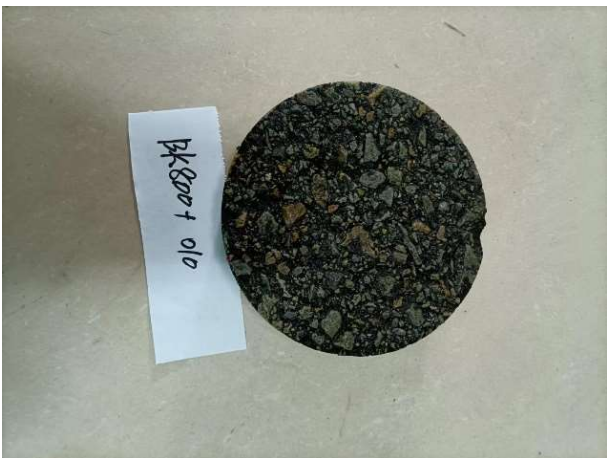
BK800+010 二车道泛白芯样分散试验
