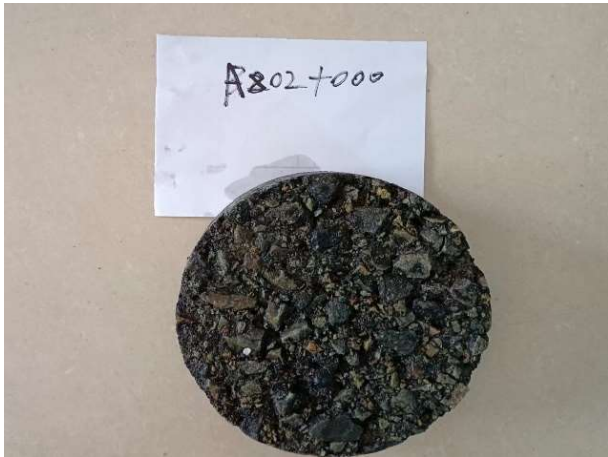
AK802+000 二车道泛白芯样分散试验
