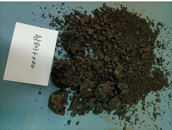
AK803+000 二车道泛白芯样分散试验
